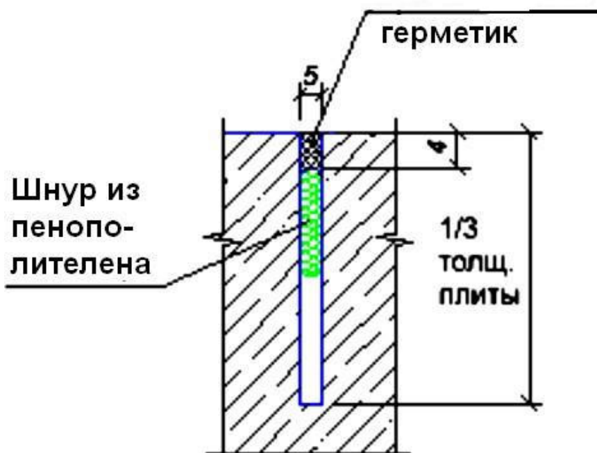
Рис. 4. Типовая конструкция температурно-усадочных швов
